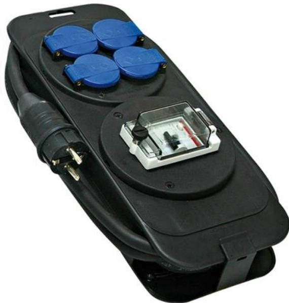
Console multiprises avec protection différentielle 30mA, câble H07RN-F 3G2,5. 4 prises 2P+T 16A/230V à clapets. IP44, pour utilisation en plein air. Distributeur de courant de fabrication robuste. Boîtier en matière isolante anti-chocs avec perçages pour fixation au mur. Guide-câble pour faciliter le rangement.
