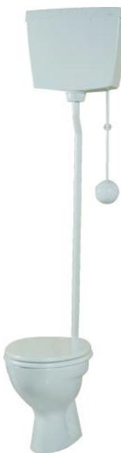
Réservoir haut pneumatique avec pousoir pneumatique apparent simple débit blanc. Isolé contre la condensation. Alimentation droite ou gauche, équipé d'un robinet flotteur 3/8" NF classe 1 silencieux. Livré avec fixations et manchon 50/32mm pour cuvette. Livré sans tube de chasse.
