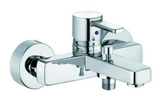
Mitigeur de bain/douche DN 15 levier plein, montage mural, débit classe CB, mousseur M24 x I, cartouche céramique avec limiteur eau chaude. Inverseurautomatique douche/bain. Sortie de douche G 1/2, sécurité contre le refoulement. Raccordements S. Catégorie de bruit I.
