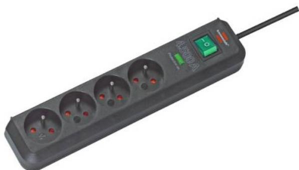
Prolongateur 4 prises avec parasurtenseur 4500A. Bloc ménager en matière isolante moulée, protection enfants. Interrupteur marche/arrêt à voyant lumineux. Voyant d'indication de protection active. Prises orientées à 45° pour un branchement optimal de plusieurs fiches coudées. Protège efficacement les appareils en cas de pics de tension ou de coups de foudre indirects. 4 prises 2P+T 16A.
