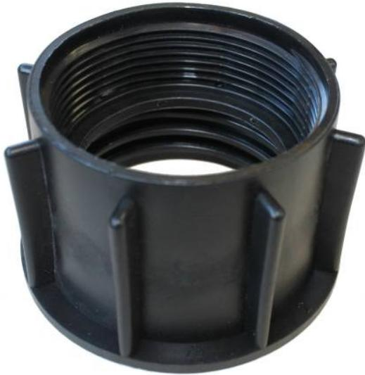
Raccord changement de pas avec écrou tournant femelle 2" S60x6 - Femelle 2" pas gaz. Adaptateur professionnel spécialement conçu pour les cuves plastiques 1000L. Il permet de changer rapidement le pas de sortie de la vanne de la cuve. Ce raccord est en polypropylène chargé fibre de verre pour une rigidité élevée et une bonne dureté.
