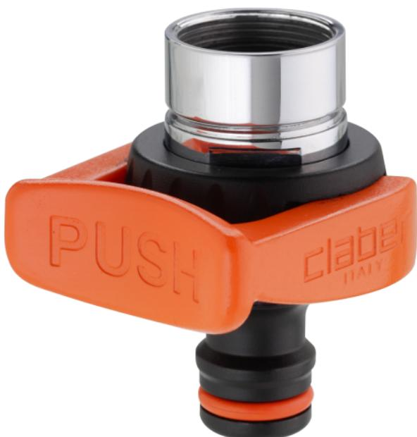
Spécial nez robinet d'intérieur de 3/4" pour brancher un tuyau dans la cuisine ou la salle de bain. Pour robinets avec filetage mâle de 22 mm ou femelle de 24 mm. Raccordement par fourche de branchement/débranchement à pression. Fourni avec filtre aérateur brise-jet et adaptateur fileté métal. Raccord Quick-Click®. Étanchéité parfaite.
