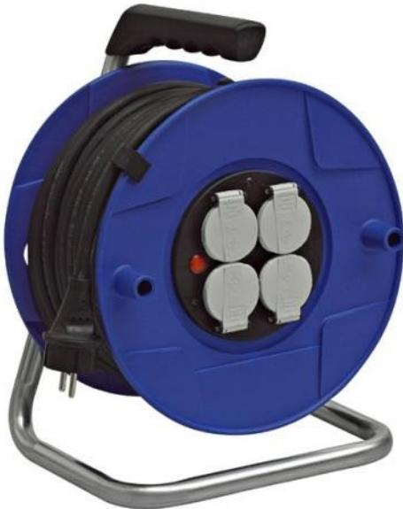
Enrouleur IP44 4 prises 2P+T 16A/230V à clapet automatique. Disjoncteur thermique. Puissance maxi câble déroulé 3500W, câble non déroulé 1000W. Protection enfants. Tambour monobloc moulé en matière très résistante, support en acier galvanisé, poignée de transport moulée aux formes ergonomiques. Conforme aux normes : NF EN 61242 de septembre 1997 et NF C 61314 de février 2008.
