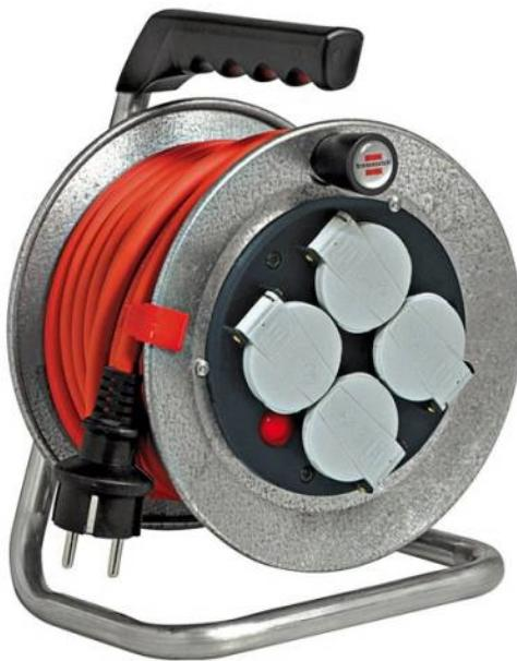
Enrouleur IP44, 4 prises 2P+T 16A/230V à clapets. Disjoncteur thermique. Puissance maxi : 3500 W câble déroulé 1000 W câble non déroulé. Protection enfants. Flasques acier galvanisé. Moyeu en matière isolante renforcé. Diamètre tambour 190mm. Support en tube acier cintré. Poignée de transport ergonomique. Conforme aux normes NF EN 61242 de septembre 1997 et NF C 61314 de février 2008.
