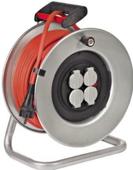
Enrouleur IP44, 4 prises 2P+T 16A/230V à clapets. Disjoncteur thermique. Puissance maxi : 3500W câble déroulé, 1000W câble non déroulé. Protection enfants. Flasques acier galvanisé. Moyeu en matière isolante renforcé. Support en tube acier cintré. Poignée de transport ergonomique avec guide-câble. Conforme aux normes NF EN 61242 de septembre 1997 et NF C 61314 de février 2008.
