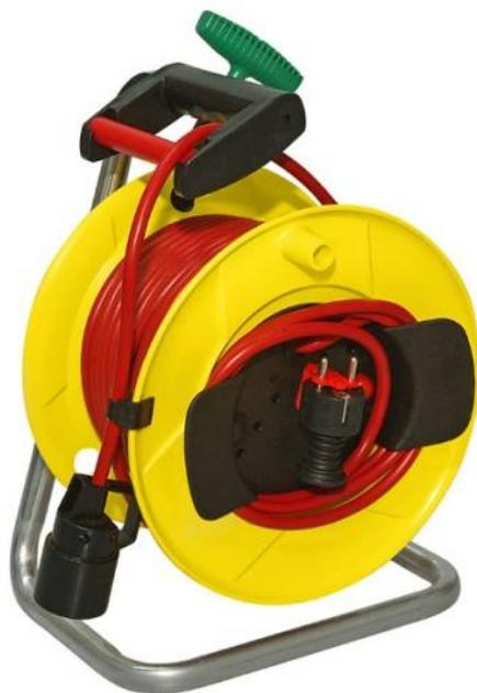
Prolongateur 2P+T 16A/230V. Disjoncteur thermique. Puissance maxi câble déroulé 3500W, câble non déroulé 1000W. Protection enfants. Tambour monobloc moulé en matière très résistante Ø 240mm. Châssis standard triangulaire en acier galvanisé. Poignée de transport ergonomique avec guide-câble. Système Rol'Up : quelques tractions sur la poignée verte et le câble est bien rangé ! Conforme aux normes NF EN 61242 de septembre 1997 et NF C 61314 de février 2008.
