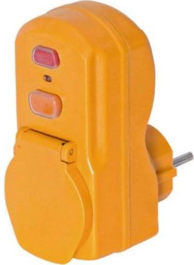
Adaptateur avec protection différentielle 30mA, IP54 pour une utilisation à l'extérieur. 1 fiche 2P+T 16A/230V, 1 prise 2P+T 16A/230V à clapet. Protection efficace contre les accidents électriques. Coupe instantanément l'alimentation électrique lors de courants de fuite. Essentiel pour vos circuits électriques mobiles. Indispensable pour les travaux avec appareils électroportatifs.
