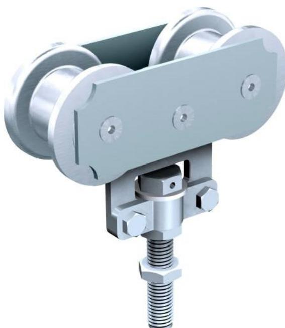
Monture avec fixation sur chant pour rail 5040, équipée de 2 galets en acier montés sur cage à rouleaux. Fonctionnement simple et durable, les montures sont conçues pour être en contact permanent avec le rail.
