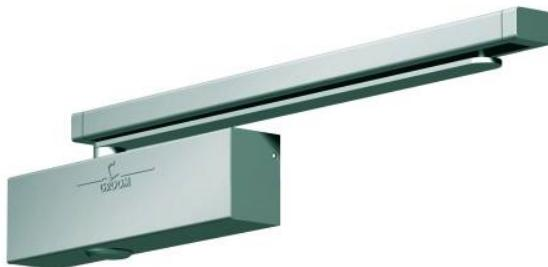
Ferme porte coupe-feu hydraulique force 3, équipé d'un bras antivandalisme. Vitesse de fermeture et à-coup final réglables par vis pointeau. Grande souplesse d'ouverture grâce à sa technologie à pignon excentré. Clapet de surpression de série. Fixations et vis de réglage invisibles dissimulées par capot clipé. Pose sur tout type de menuiserie (bois, alu, PVC).
