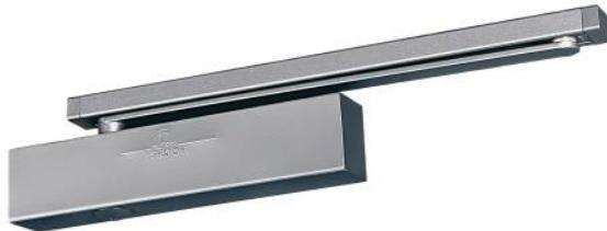
Ferme porte coupe-feu hydraulique à force variable 3 à 5, équipé d'un bras anti-vandalisme. Grande souplesse à l'ouverture grâce à sa technologie à pignon excentré. Vitesses de fermeture et à-coup final réglables par vis pointeau. Frein à l'ouverture de série réglable par vis pointeau. Clapet de suppression de série. Fixations et vis de réglage invisibles dissimulées par capot clipé. Esthétique, grâce à son bras sans fixations visibles. Pose sur tout type de menuiserie (bois, alu, PVC).
