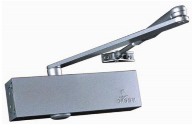
Ferme porte coupe-feu hydraulique à force variable 2 à 4, bras réglable. Vitesse de fermeture et à-coup final réglables par vis pointeau. Frein à l'ouverture de série réglable par vis pointeau. Clapet de surpression de série. Fixations invisibles dissimulées par capot clipé. Large gamme d'accessoires permettant notamment d'équiper les portes en verres.
