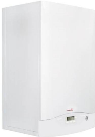
Chaudière pour chauffage et ECS. Gaz basse température. Accumulation 60L. Système de stockage ECS en inox associé de 60L. Modulation intégrale de la puissance entre 40 et 100%. Fonctionnement gaz naturel avec possibilité de transformation au GPL (versions ventouse et cheminée). Filtre chauffage intégré et visitable permet de protéger le corps de chauffe.
