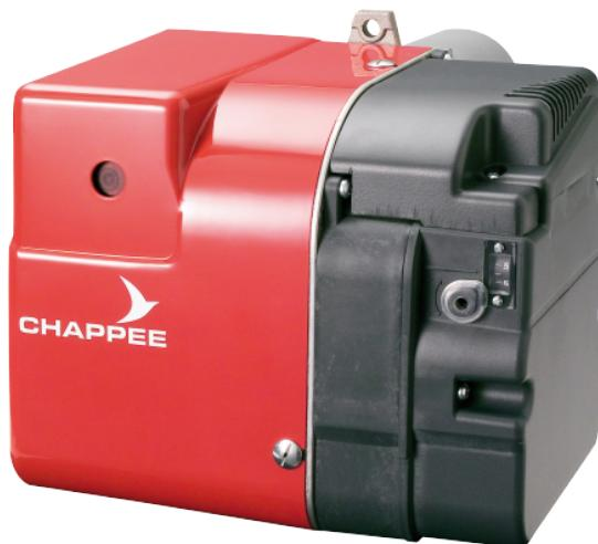
Brûleur flamme jaune pour chaudière fioul de 23 à 32 kW. Carter en aluminium injecté, capot en plastique, tuyère de combustion en acier inoxydable, 2 flexibles longueur 1m avec raccords tournants 3/8" femelle, 2 mamelons 3/8" mâle/mâle, bride de fixation coulissante, joint d'étanchéité, gicleur, connecteurs mâles 7 broches de raccordement chaudière, clé de réglage, vis de fixation M8.
