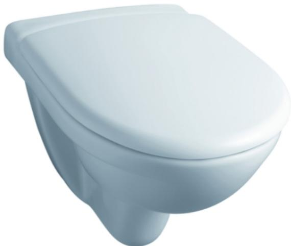
Se fixe à la hauteur idéale : bas pour les enfants, surélevé pour les personnes à mobilité réduite. Hauteur de fixation réglable à l'aide du bâti-support. Entretien facilité du fait de l'absence de pied au sol. Fonctionnement 6L. Entraxe: 180 mm. Fixation à déterminer suivant la nature des murs. Livrée sans abattant.
