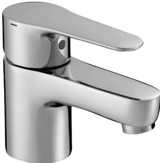
Mitigeur monotrou. Tirette latérale. Aérateur anti-calcaire. Levier métal, bonde de vidage mixte. Cartouche Eco+ à disques céramique avec limiteur de température et de débit. Avec flexibles d'alimentation. Saillie du bec 105mm.
