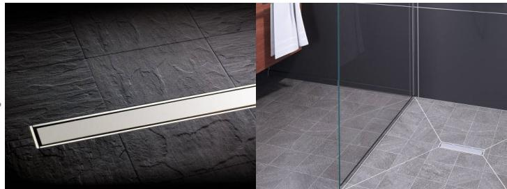
Profondeur de pose ultra réduite (80mm) idéale en rénovation. Grille tout inox , réversible et carrelable. Corps en ABS parfaitement lisse pour un nettoyage simple et parfait. Débit élevé 30 à 36L/mn.
