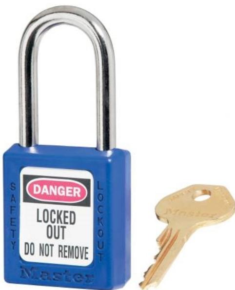
Corps en thermoplastique non-conducteur de 38x44mm, anse avec écartement de 38mm. Conçu spécifiquement pour les applications de consignation/signalisation. Personnaliser le corps du cadenas avec des étiquettes inscriptibles permanentes. Conformité à OSHA à la norme "un employé, un cadenas, une clé". Cylindre haute sécurité, prévient la duplication des clés. Système de retenue de clé garantissant que le cadenas ne reste pas déverrouillé. Cylindre à 6 goupilles à clés différentes.
