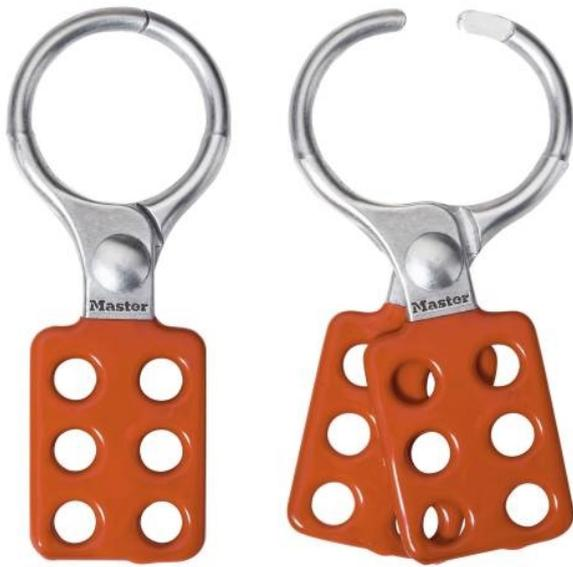
Permet la consignation simultanée de plusieurs employés à un même point de consignation. Maintient l'équipement hors d'usage pendant les opérations de maintenance ou de réparation. L'équipement ne peut être réactivé sans que le dernier cadenas n'ait été retiré du morillon. Aluminium anti-étincelles. Diamètre intérieur de mâchoire de 38mm, jusqu'à 6 cadenas peuvent être accrochés.
