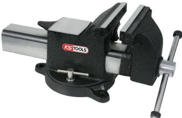
Etau d'établi pivotant 360° à mors interchangeables. Mors à tubes inclus. Serrage parfaitement parallèle grâce à un guidage central. Hauteur des mors spéciale pour une meilleure prise. Enclume à grande surface pour plus de facilité de travail. Mors et enclume durcis, mors, enclume et partie coulissante polis. Ouverture vers l'avant.
