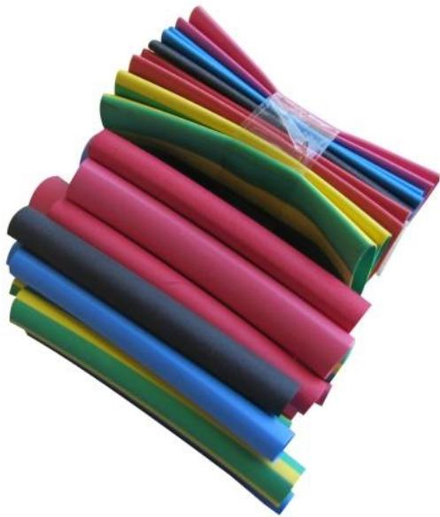
Isolation et repérage des câbles de 1,5 à 6mm<sup>2</sup>. A utiliser entre -55 et 135°C. Température de retreint 90°. Coefficient de retreint 2:1. Isolation électrique 600V. Matière polyoléfine. Coloris rouge, bleu, noir, blanc, vert/jaune. Longueur 50mm.
