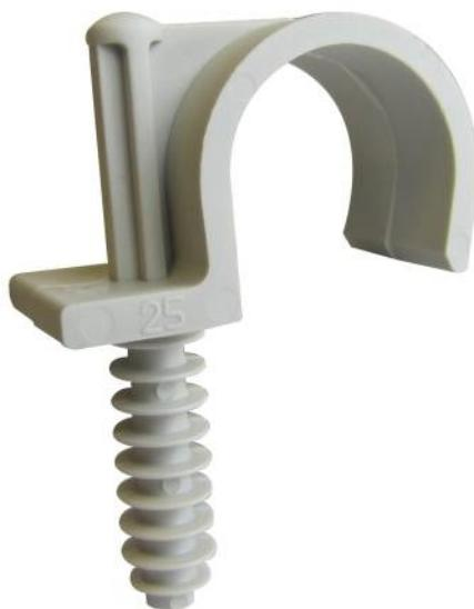
Fixation de câbles rigides ou souples, tubes et gaines dans cloison pleine en brique, béton... Diamètre de perçage 8mm. Matière polyamide. Fixation économique, rapide et efficace avec de multiples utilisations.
