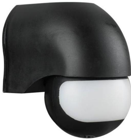
A brancher sur un appareil d'éclairage avec ampoule incandescente ou halogène 1200W maxi sous 230/240V. Angle horizontal 180°, portée 10m environ. 2 réglages : temporisation de 5sec à 8min et sensibilité de la lumière (jour, nuit). Tête orientable 180° à la verticale et 160° à l'horizontale. IP44.
