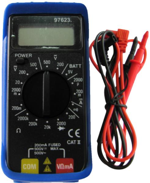
Testeur 5 fonctions : mesure de la tension 500V AC/DC, de l'intensité 200mA maxi DC, de la résistance (ohmmètre) 2MOhms maxi, de la continuité avec buzzer, des diodes. Housse antichoc. Pile fournie.
