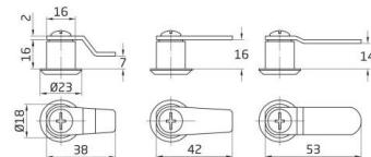
Serrure de boîte aux lettres avec finition nickelée. Trois cames de tailles différentes. Largeur maximale : 16 mm. Rotation de la came pour verrouiller ou déverrouiller la porte de la boîte aux lettres. Modèle de clés brutes 371. Livré avec 3 cames et 2 clés.
