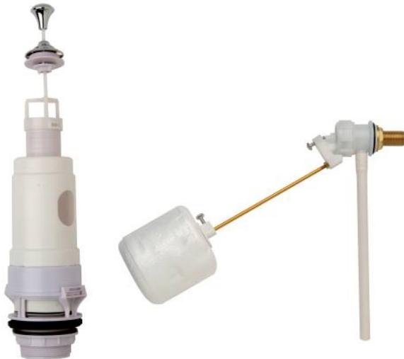
Mécanisme à tirette , bouton chromé. Surverse ajustable (de 195 à 235 mm). S'adapte à tout réservoir standard. Hauteur réservoir de 310 à 380mm. Trou de couvercle de 11 à 40mm. Livré complet avec joints et fixation cuvette. Robinet d'alimentation latérale, embout 3/8" laiton. Fermeture instantanée à levier. Niveau d'eau réglable. S'adapte à tout réservoir à alimentation latérale.
