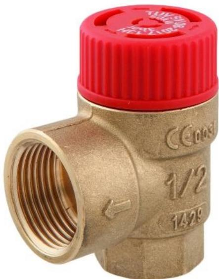
Protège contre une élévation de la pression des circuits fermés des installations de chauffage selon EN 12828 pour les liquides suivants : eau et mélange eau + glycol. Raccord de sortie en 1/2" F.
