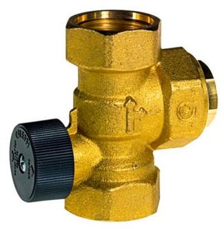
Le clapet antithermosiphon évite le phénomene de thermosiphon dans l'installation de chauffage central. Quand le circulateur est arrété, en été, ou quand la chaudière ne sert qu'à la production d'eau chaude sanitaire le clapet empèche toute circulation parasite dans le circuit de chauffage central. Corps laiton matricé. Joint Etylène-propylène. Ressort acier inox. Pression maxi 10 bar. Température maxi 110°C. Clapet débrayable (permet la vidange). Pression d'ouverture: 0,02 bar. Corps laiton.
