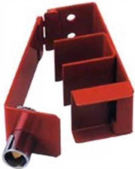
Cravate de verrouillaged'échelle pour cage d'escalier. Fermeture par triangle pompier section de 14mm protégé. En acier de 3mm d'épaisseur, finition époxy rouge. Livré sans clé triangle pompier.
