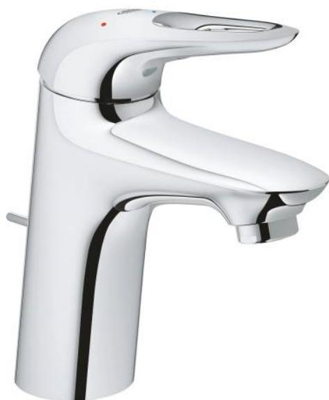
Mitigeur monocommande 1/2" lavabo. Monotrou sur plage. Chrome éclatant et durable. Cartouche en céramique 35mm avec butée éco et ouverture eau froide. Levier de commande métallique. Limiteur de débit ajustable. Mousseur. Tirette et garniture de vidage 1" 1/4. Flexible de raccordement souple. Système de montage rapide.
