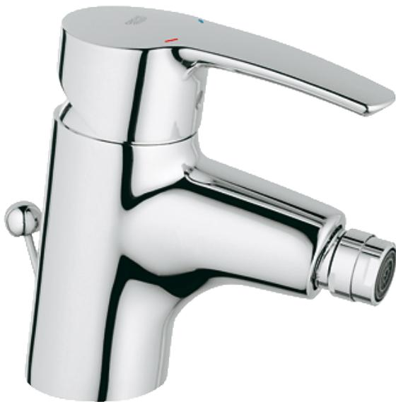
Mitigeur monocommande 1/2" bidet. Monotrou sur plage. Chrome éclatant et durable. Cartouche en céramique 35mm avec butée éco et ouverture eau froide. Levier de commande métallique. Limiteur de débit ajustable. Mousseur à rotule. Tirette et garniture de vidage 1" 1/4. Flexible de raccordement souple. Système de montage rapide.
