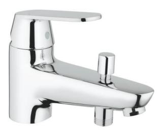
Mitigeur monocommande 1/2" bain/douche. Monotrou sur plage. Chrome éclatant et durable. Cartouche en céramique 46mm avec butée éco 1/2 débit. Levier de commande métallique. Inverseur automatique bain/douche. Clapet anti-retour intégré dans le départ de douche 1/2". Mousseur. Flexible de raccordement souple.
