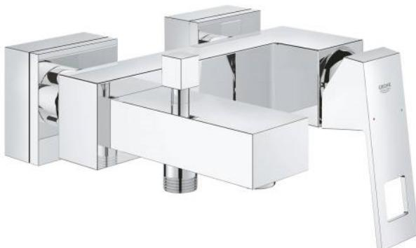
Mitigeur monocommande 1/2" bain/douche. Montage mural apparent. Chrome éclatant et durable. Cartouche en céramique 46mm. Levier de commande métallique. Limiteur de débit ajustable. Inverseur automatique bain/douche. Clapet anti-retour intégré dans le départ de douche 1/2". Mousseur. Raccords S à rosaces.
