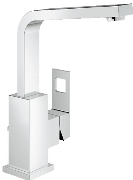
Monotrou sur plage. Levier de commande métallique. GROHE SilkMove Cartouche en céramique 28 mm. Limiteur de température ajustable. Brillance éclatante année après année. Consommation d'eau réduite, jet parfait. Mousseur SpeedClean, procédé anti-calcaire. Installation ultra rapide. Bec mobile avec butée. Tirette et garniture de vidage 1,1/4". Flexibles de raccordement souples 3/8. Débit maximum : 5 l/min à 3 bars
