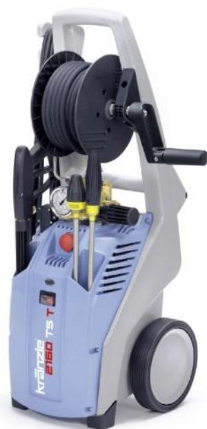
Nettoyeur haute pression eau froide. Pompe en laiton, piston céramique, siège clapet inox, manomètre en inox. Système total-stop, logements pour les lances et la poignée, dispositif aspiration savon.
