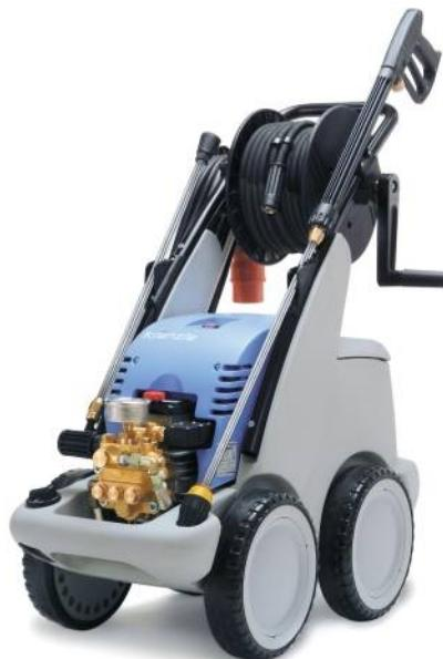
Nettoyeur haute pression eau froide, chariot 4 roues intégré. Régulation progressive de la pression. Tête de pompe en laiton spécial, pistons céramique, siège clapet inox, manomètre en inox. Sécurité contre la marche à sec. Système total-stop avec retardateur d'arrêt du moteur, coupe-circuit automatique (après 20 minutes). Logements pour pistolet et lance et turbobuse. Bac tampon intégré. Système d'aspiration de détergent avec filtre.
