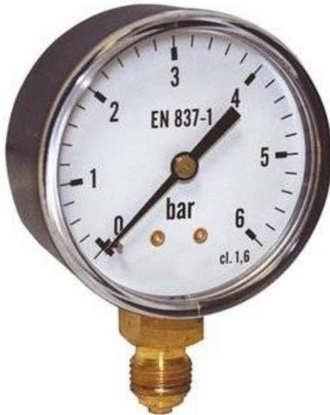
Manomètre classe 1,6 et 2,5. Tube de bourdon en cuivre soudé à l'étain. Pour tous fluides non corrosifs. Température de -10 °C à +80 °C.
