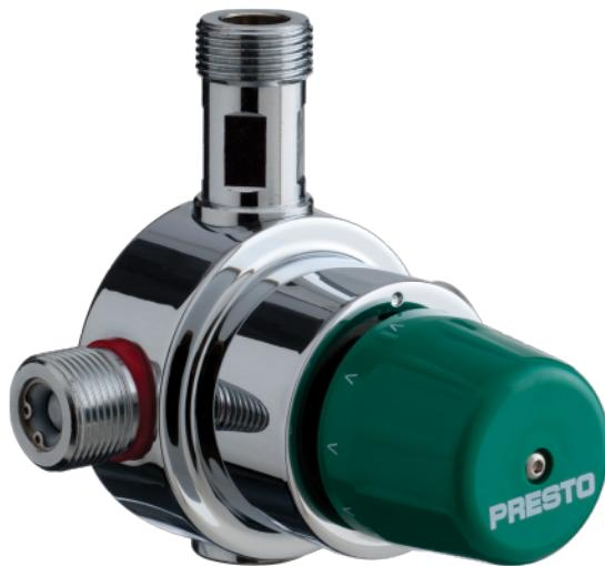
Le mitigeur centralisé PrestoTherm permet de délivrer une mitigée à température constante quelque soit les variations de pressions et de températures aux entrées. En cas de coupure d'eau froide, le mitigeur stoppe instantanément la distribution d'eau mitigée. Température constante même à faible débit, sécurité anti-brûlure en cas de coupure de l'eau froide, blocage de température interne. Clapets anti-retour NF.
