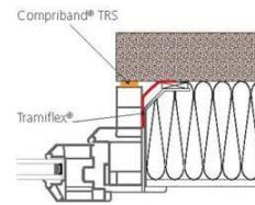
Etanchéité sous appui de menuiserie - Pose en tunnel avec isolation thermique par l'extérieur.
