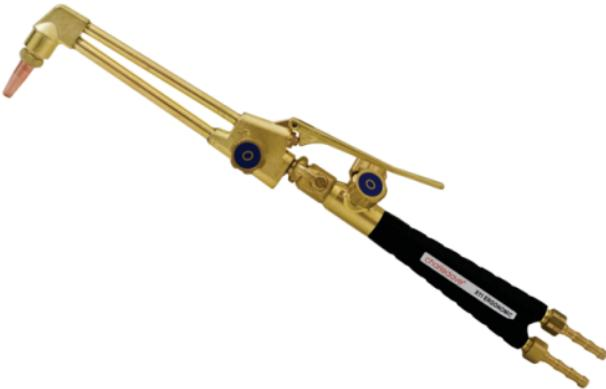
Le X11 Ergonomic est un chalumeau à lances interchangeables. Son système breveté de fixation des lances (débrayage manuel de la lance avec étrier) permet à l'utilisateur de passer de l'une à l'autre en quelques secondes. Suivant le travail à effectuer, l'opérateur peut passer en quelques secondes et sans outil, d'une lance de soudage à une lance malléable, à un bec multidards et même à une lance de coupe.
