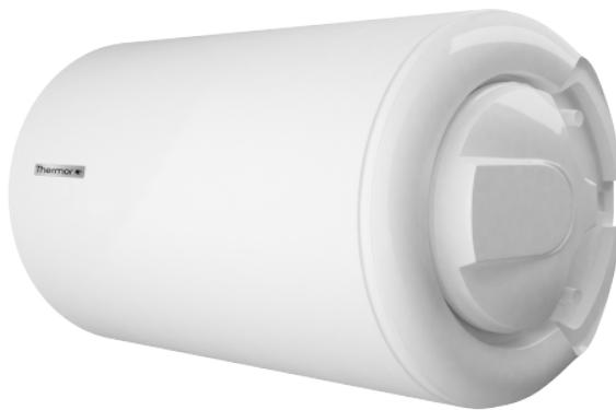
Chauffe-eau horizontal blindé à raccordement sur le côté. Cuve conforme aux normes d'hygiène grâce à son revêtement intérieur en émail vitrifié à haute teneur en quartz. Anode magnésium à durée de vie prolongée grâce à la résistance compensatrice. Berceau de fixation de série pour installation au mur, au sol ou au plafond.
