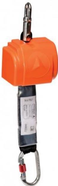
Antichute gamme Expert à rappel automatique à sangle polyester de 46mm avec dissipateur d'énergie, équipé d'un connecteur acier à vis type AM002. Capot de protection contre les chocs et les corps étrangers. Equipé d'un témoin de chute. Fonctionne aussi sur plan incliné.
