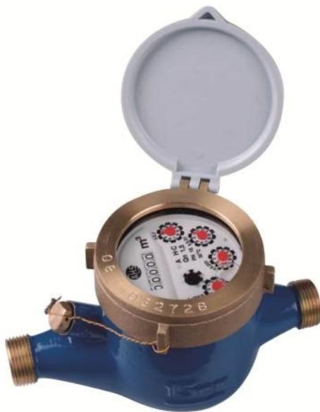
Pression de service 16 bar. Jets multiples. Cadran noyé. Classe B : en position horizontale ou verticale classe A. Filetage 1". Calibrage 20mm. Longueur 190mm. Hauteur 109mm.
