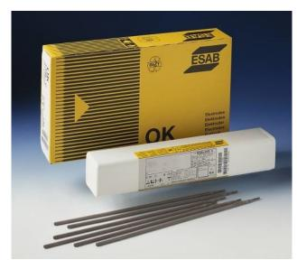
OK 67.60 est une électrode rutile pour acier inoxydable réfractaire du type 24Cr12Nià très bas carbone. Elle est destinée au soudage des aciers de même nuance. Assemblage hétérogèneaciers au carbone avec aciers inoxydables, également recommandée pour la réalisation des premières passes sur aciers plaqués.
