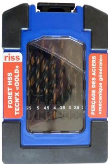
Coffret de forets HSS Tecn'X Gold autocentreur pour le perçage des aciers. Acier HSS - Din 338-N. Queue avec 3 méplats pour diamètre supérieur à 5mm. Angle au sommet 135°. Affûtage en croix Din 1412C. Angle hélice 30°. Tolérance H8.
