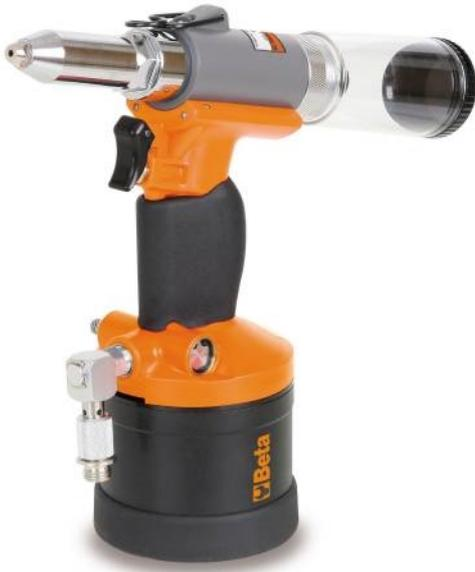
Riveteuse professionnelle pour rivets en acier, acier inoxydable, aluminium et cuivre. Bec conique à pointe. Puissant et maniable, avec poignée en composite. Avec déflecteur récupérateur de clous et seringue de lubrification. Pour rivets de 2,4 - 3,2 - 4,0 - 4,8mm.
