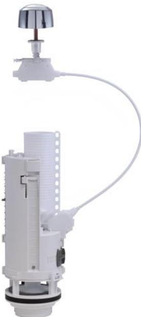
Mécanisme double volume spécial rénovation, compatible avec trou de réservoir 6mm. Mécanisme de chasse spécial rénovation, économiseur d'eau double volume compact, compatible avec les trous de réservoir 6mm. Modèle à câble permettant une grande souplesse de la fixation du couvercle du réservoir, bouton auto réglable chromé, hauteur ajustable entre 332 et 492mm. Diamètre trou d'évacuation compris entre 58 et 72mm, petite chasse réglable, trop plein, niveau d'eau résiduel réglable.
